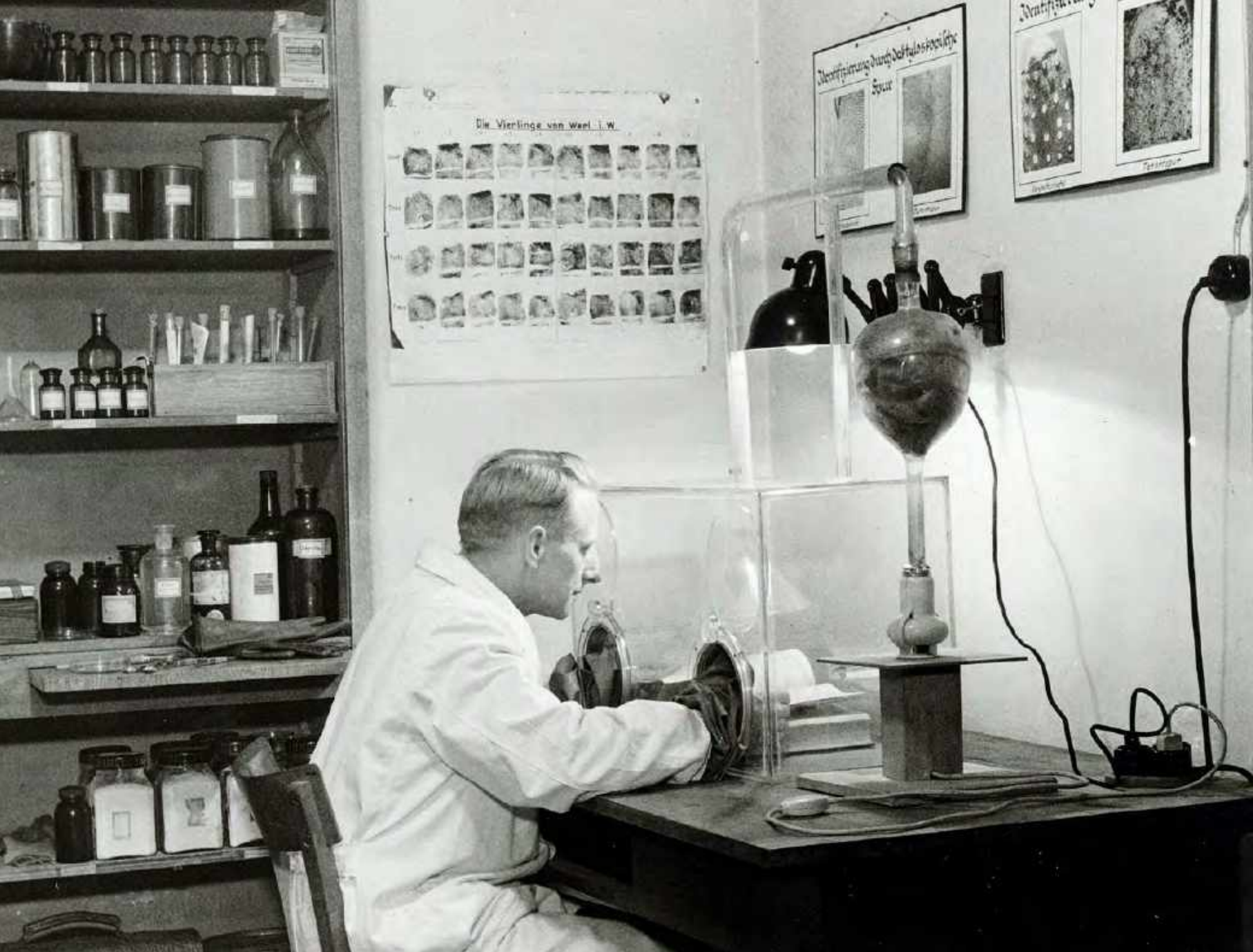
Jodbedampfer Marke Eigenbau: Mit einer abenteuerlichen Konstruktion gehen die Kriminaltechniker auf die Suche nach Fingerabdrücken.
