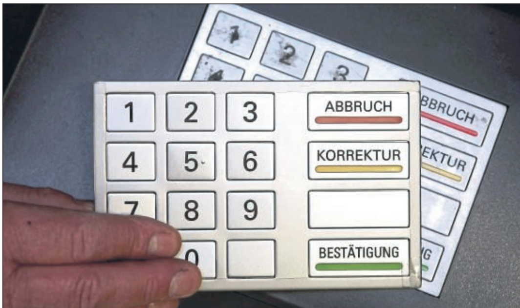
Tastenfeld-Attrappe: Das zweite Tastenfeld sieht täuschend echt aus. Durch diese Manipulation kann die Pin von Bankkunden ausgespäht werden.
